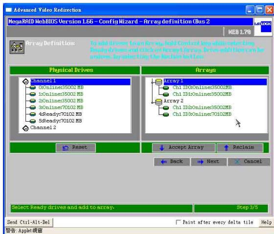
7. 點選【Array 1】設定為 RAID 1，並將【Span】選項選擇【Enabled】（開啟）。接著參考下圖圈選中的資訊中 With Spanning 下 RAID 1 size 數值，在【Select Size】選項中鍵入【RAID 1 Size =】的數值，然後點選【Accept】，再按【Next】。
