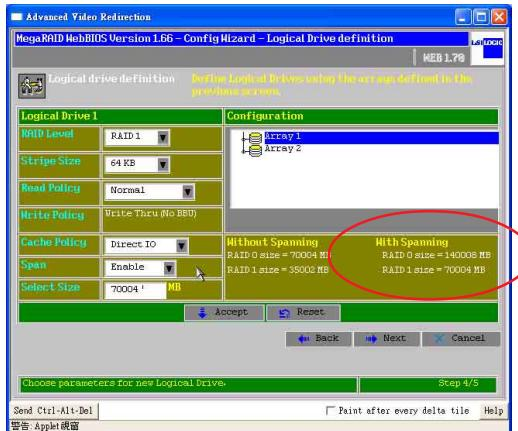
以上步驟7和圖片為採用韌體為 1L26 或 1Z26 版本使用，若您的韌體版本為 1I37 或 1Z37，則設定的步驟為：當您設定好 RAID 1，並將 [Span] 設定為 [Enable]，接著輸入 Array 1 旁所顯示 “R1=(size)” 大小之後，按住 <Ctrl> 鍵，並同時點選 Configuration 視窗下的 Array 1 和 Array 2，然後點選 [Accept]，接著再按 [Next]。
