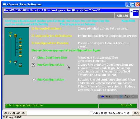
3. 若需要自行採用手動的方式設定，請點選【Custom Configuration】；也可以點選【Auto Configuration】，讓【Configuration Wizard】自動設定 RAID。
