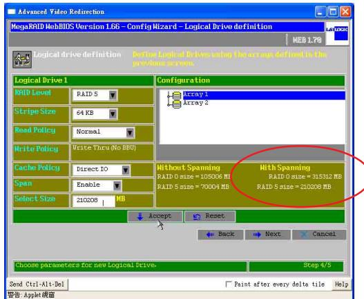
以上步驟7和圖片為採用韌體為1L26或1Z26版本使用，若您的韌體版本為1I37或1Z37，則設定的步驟為：當您設定好RAID5，並將[Span]設定為[Enable]，接著輸入Array1旁所顯示“R5=(size)”大小之後，按住<Ctrl>鍵，並同時點選Configuration視窗下的Array1和Array2，然後點選[Accept]，接著再按[Next]。
