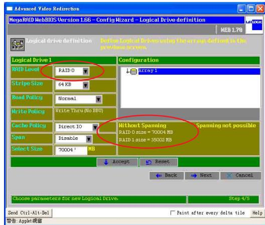
7. 如果設定為 RAID 1 等級，您也可參考以下圖上所圈起來的【RAID】狀態，其中 RAID 1 size 所顯示的容量來設定【Select Size】內的數值。例如：RAID 1 size = 35002 MB，然後點選【Accept】，接著再點選【Next】。
