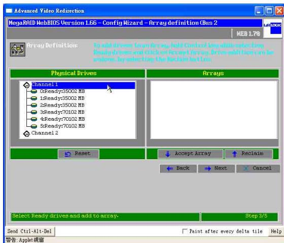
5. 接著請按住 <Ctrl> 鍵，並用滑鼠左鍵點選 3 個 Ready Drives，然後點選【Accept Array】，將前 3 顆硬碟設定為 Array 1。
