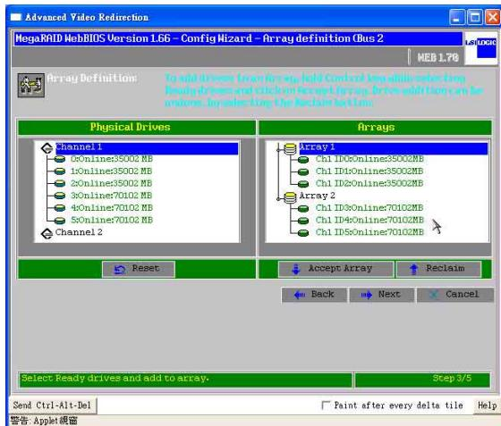
7. 點選【Array 1】設定 RAID 狀態為 RAID 5，並將【Span】選項選擇【Enabled】（開啟）。接著參考下圖的圈選中的資訊中 With spanning RAID 5 數值，在【Select Size】選項中鍵入【RAID 5 Size =】的數值，然後點選【Accept】。
