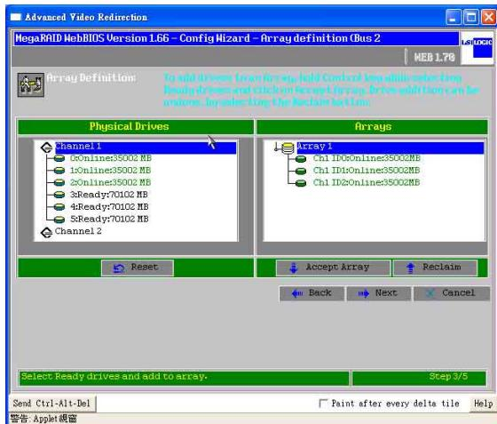
6. 然後再將後 3 顆硬碟設定為 Array 2，接著點選【Accept Array】，完成後右邊視窗（Arrays）會顯示 Array 1 和 Array 2 後，接著再點選【Next】。
