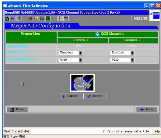
3. 用滑鼠點選【SCSI Capabilities】上的箭頭圖示，可以進行更改其執行速度：Fast、Ultra、Ultra-II、U160、U320。選好後，點選【Submit】來儲存已更改的設定。
