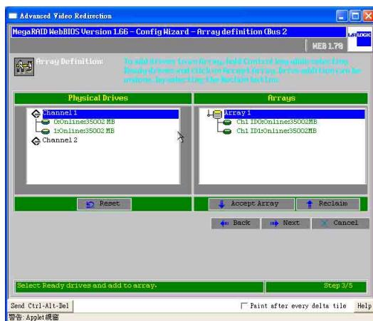
6. 請先選擇 RAID 等級 (RAID 0 或 RAID 1) 後，再依據下方顯示 RAID 容量大小，並在【Select Size】內手動輸入數值，然後點選【Accept】，接著再點選【Next】。例如：設定為 RAID 0 等級後，輸入 RAID 0 size = 70004 MB，然後點選【Accept】，接著再點選【Next】。
