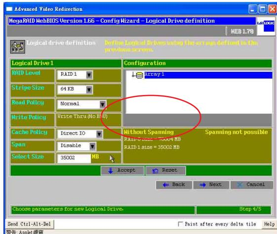
8. 在底下圖的右邊 Logical Drivers 視窗中，則顯示您設定完成的 RAID 狀態。請點選【Accept】進行下一個步驟：
